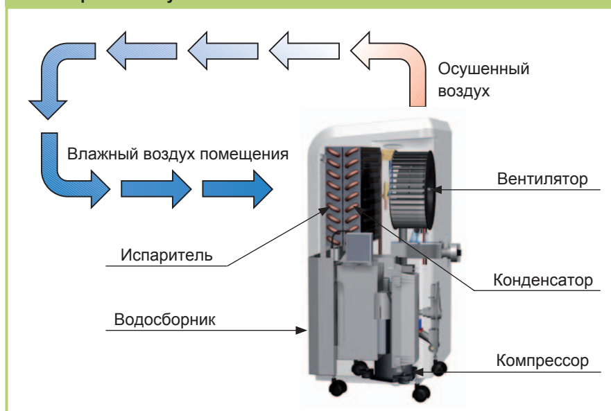
Схема работы осушителя REMKO
