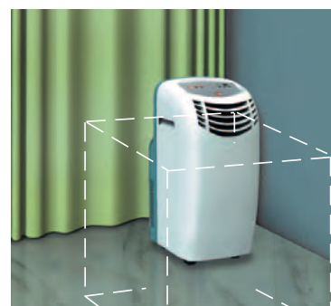
Рис. 2 Минимальные свободные зазоры Сбоку 500 мм Спереди 500 мм Сзади 400 мм Сверху 100 мм
