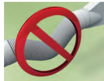
Рис. 7 Воздухоотводной патрубок должен располагаться с постоянным подъемом
